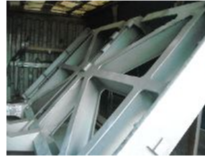
Utillaje conformado alas Airbus: 4m X 3m (1,1 Tn)
